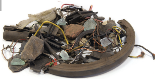
Frazione pesante proveniente dal classificatore ad aria SGM pronta per il separatore a sensore per i metalli
